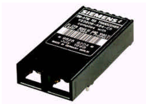
Abbildung 41: Optischer Transceiver zur Übertragung von Daten (155Mbd) über Singlemode-Glasfaser [Sie99]
